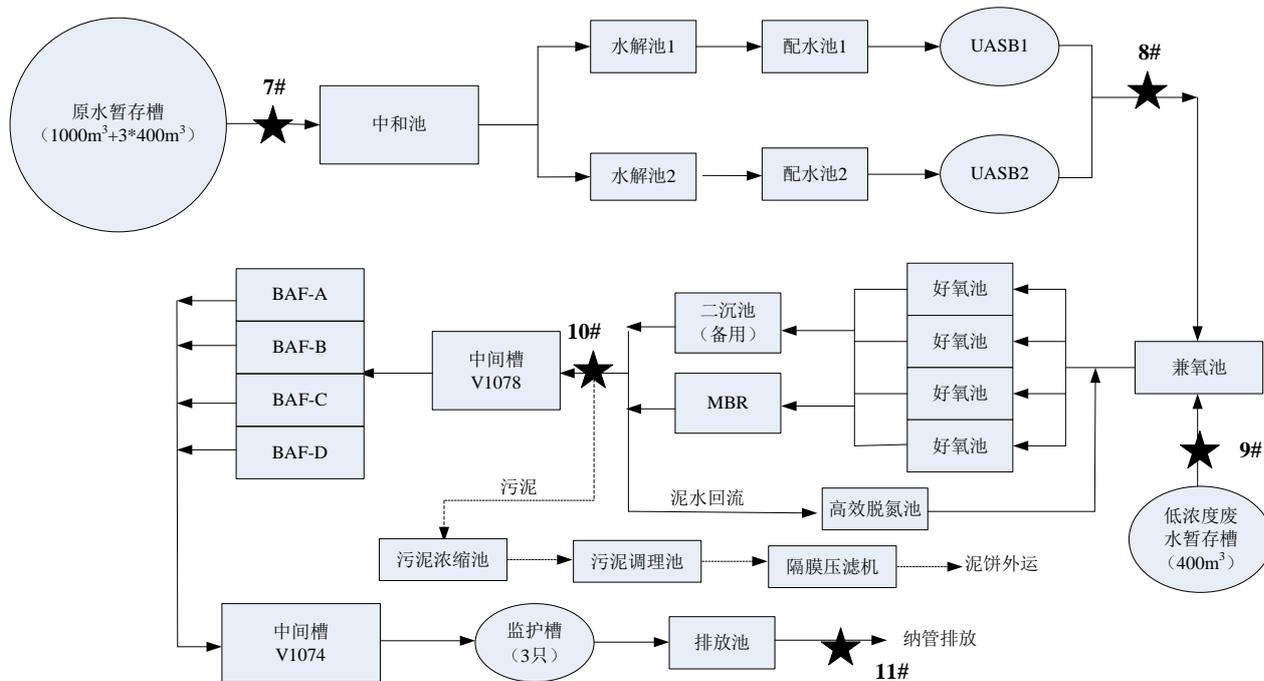
图 7.1-2 综合废水处理系统监测布点图
