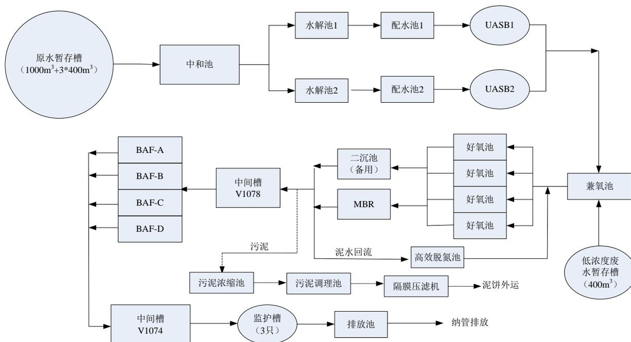
图 4.1-2 6#厂区(东厂区)综合废水处理工艺流程
