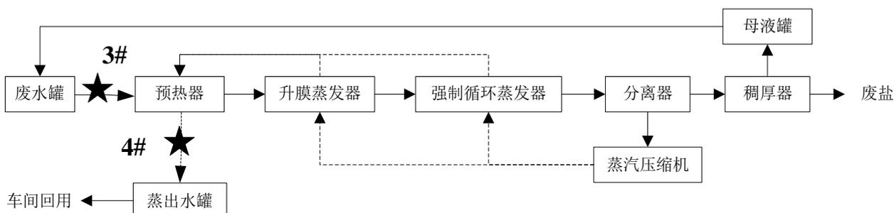
图 7.1-1 蒸发脱盐预处理系统工艺流程图
